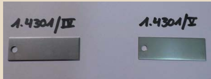
Abb. 3 Prüfkörper IV (salzsaure Chlordioxidlösung) und V (pH-neutrale Chlordioxidlösung) nach 120 h Einwirkzeit in Chlordioxidlösung ca. 50 ppm
